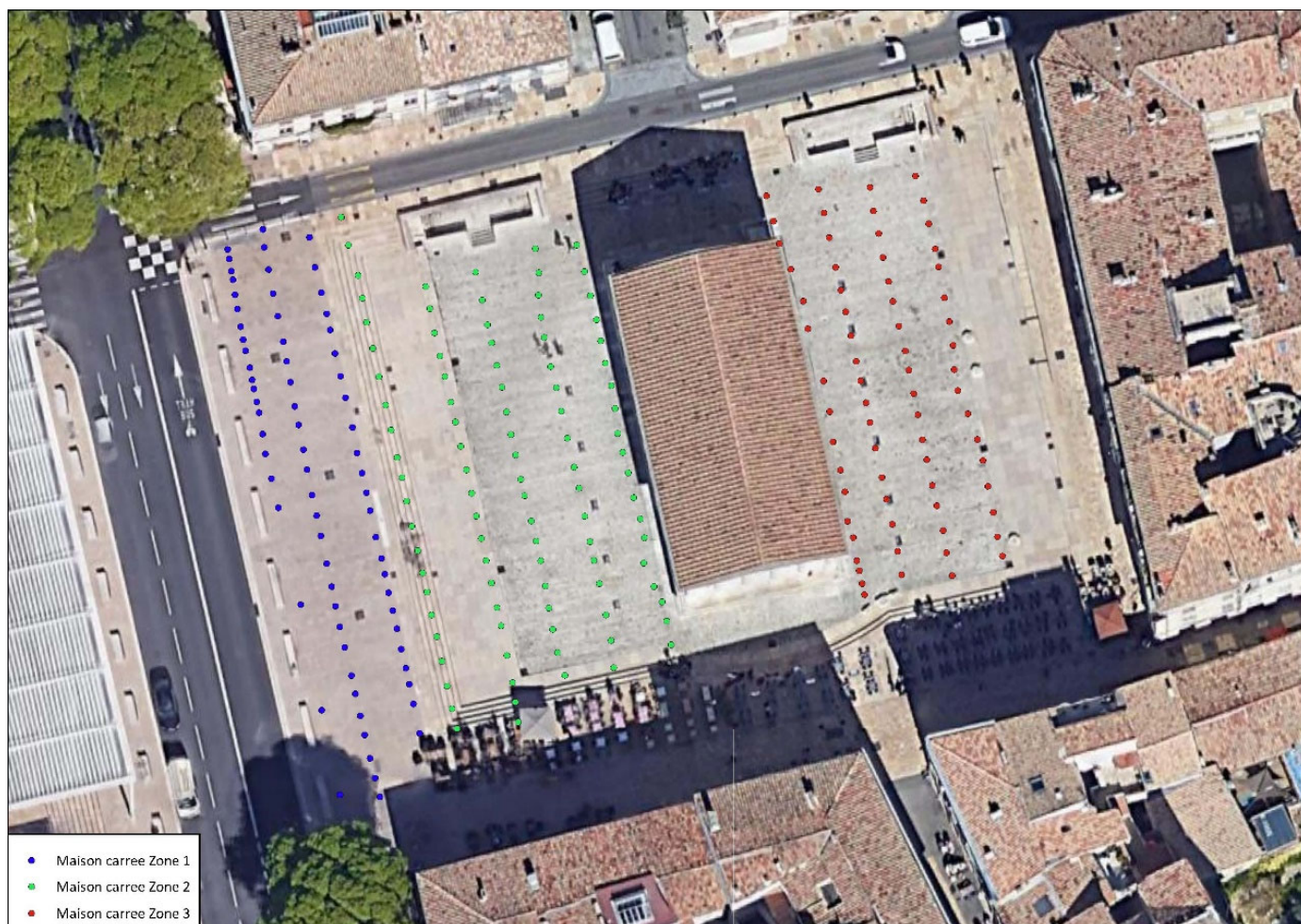
Image 5 – Points de relevés éclairage horizontal
